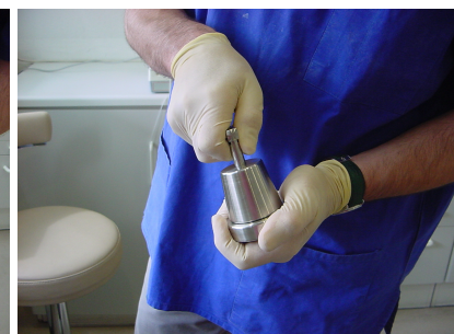
Anschlag erreicht Jetzt mit Gefühl die Restlamelle zerkleinern.
