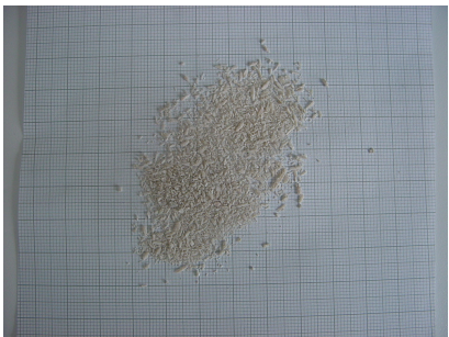
Spangrößen aus KnB4 und die Vergrößerung (aus Tab.1)
